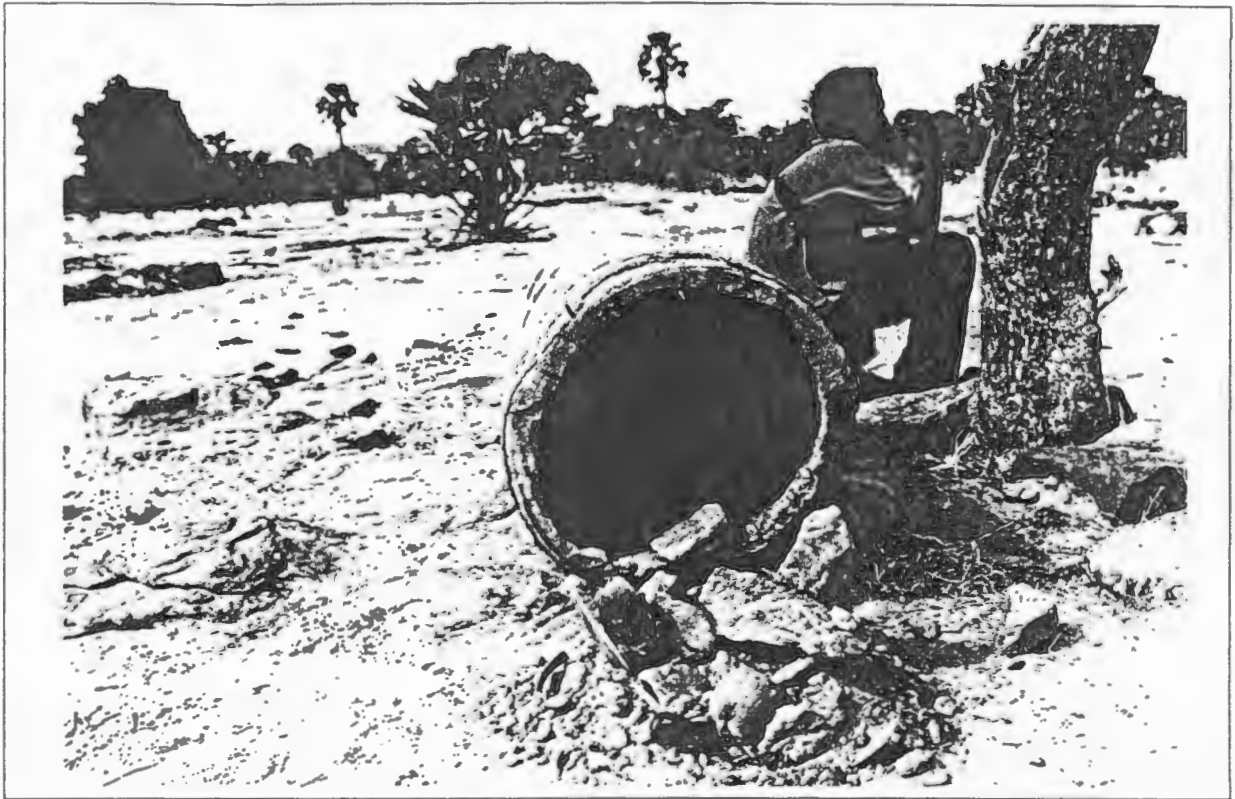
La ruche traditionnelle: illustration de la grande résistance aux termites de la partie extérieure noire du rônier. Cette section d'un pied de rônier a été posée verticalement sur le sol pendant quelques semaines: la partie blanche a été entièrement dévorée et le bois noir est intact.
