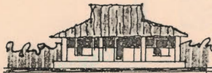
Hình 7: NHÀ CHUYÊN TIẾP - KHUNG NHÀ GỖ MÁI TRANH, TƯỜNG PHÊN TRE
