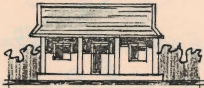
Hình 6: NHÀ CHUYÊN TIẾP, KHUNG NHÀ GỖ MÁI NGÓI, TƯỜNG TÓC XÌ
